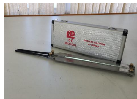
وسایل اندازه گیری ابعادی و مرجع: کولیس ، میکرومتر، خط کش، گونیا، شاقول، نوار محیط سنج ✓ تعیین اندازه طول قطرهای داخلی خارجی، ضخامت لوله های پلاستیکی ✓ و تعیین اندازه نمونه برای سایر نمونه ها ✓ دماسنج
