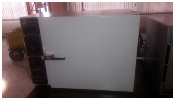
آون: سال نصب ۱۳۹۵ ✓ خشک کردن و رطوبت زدایی ✓ تعیین بازگشت طولی لوله های ترموپلاستیک
